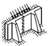
Рис.3. Растворение кладки при изгибе по перевязанному сечению
