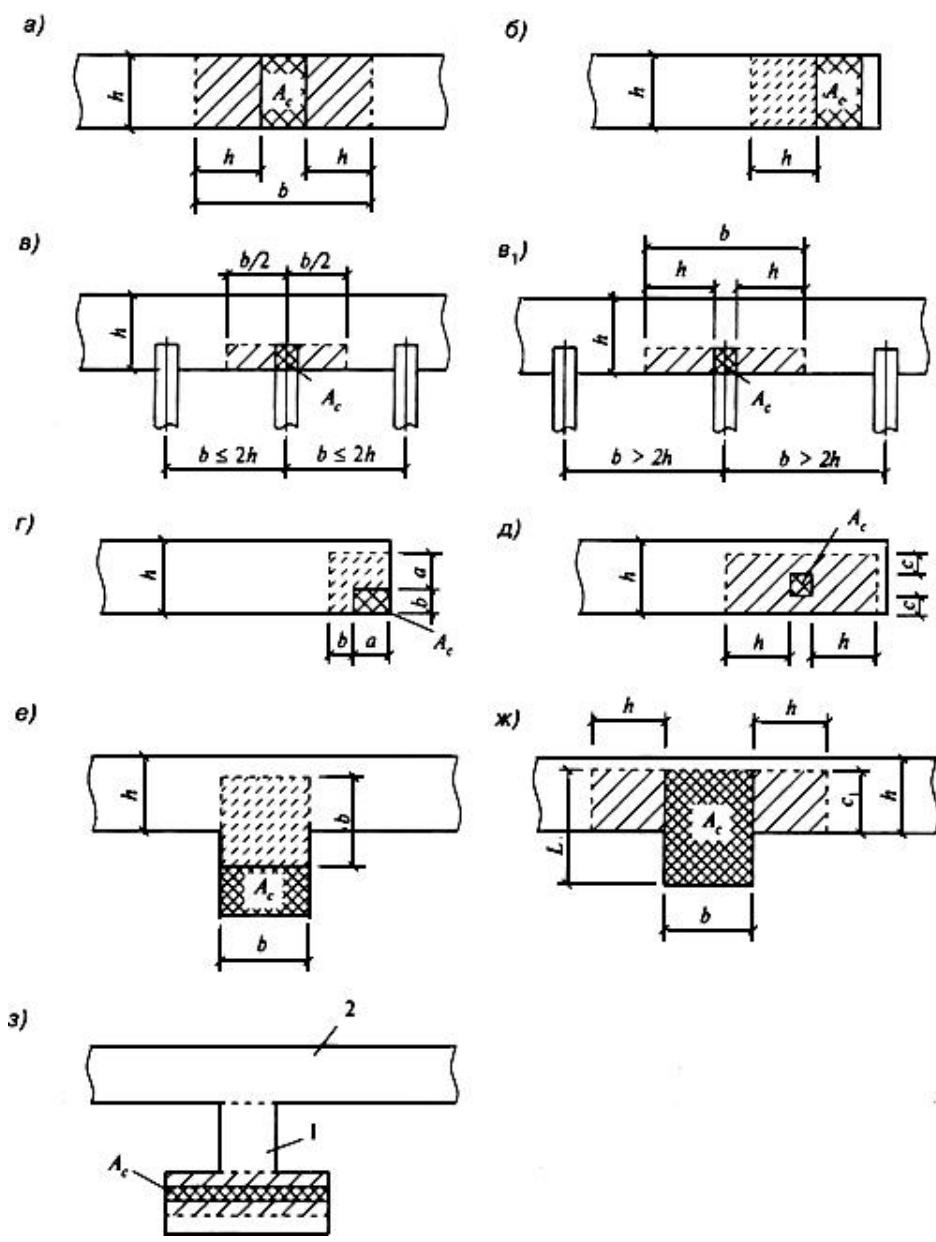
Рис.9. Определение расчетных площадей сечений при местном сжатии
