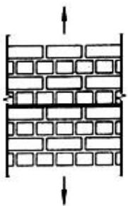
Рис.1. Раствжение кладки по неперевязанному сечению
