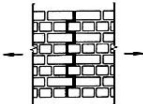
Рис.2. Раствжение кладки по перевязанному сечению
