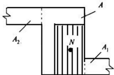
**Рис.8. Расчетная схема сложного сечения при косом внецентренном сжатии;**
